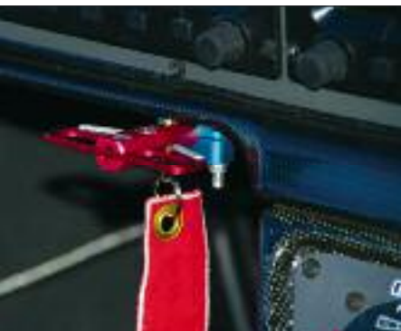
Dźwignia systemu ratowniczego pod tablicą
