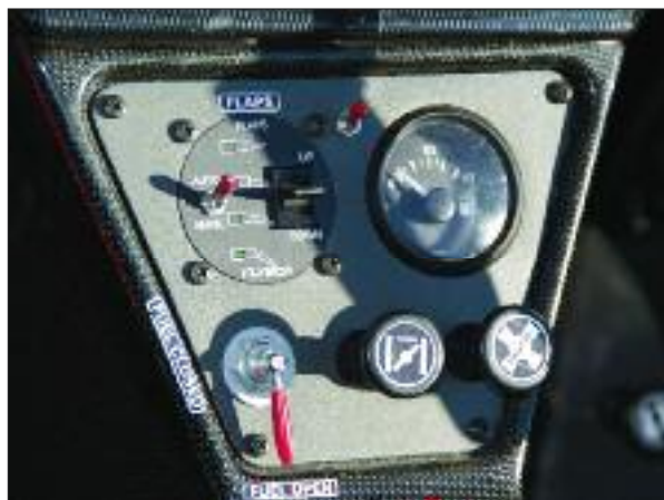
Kran paliwa filigranowy, ale na widoku
