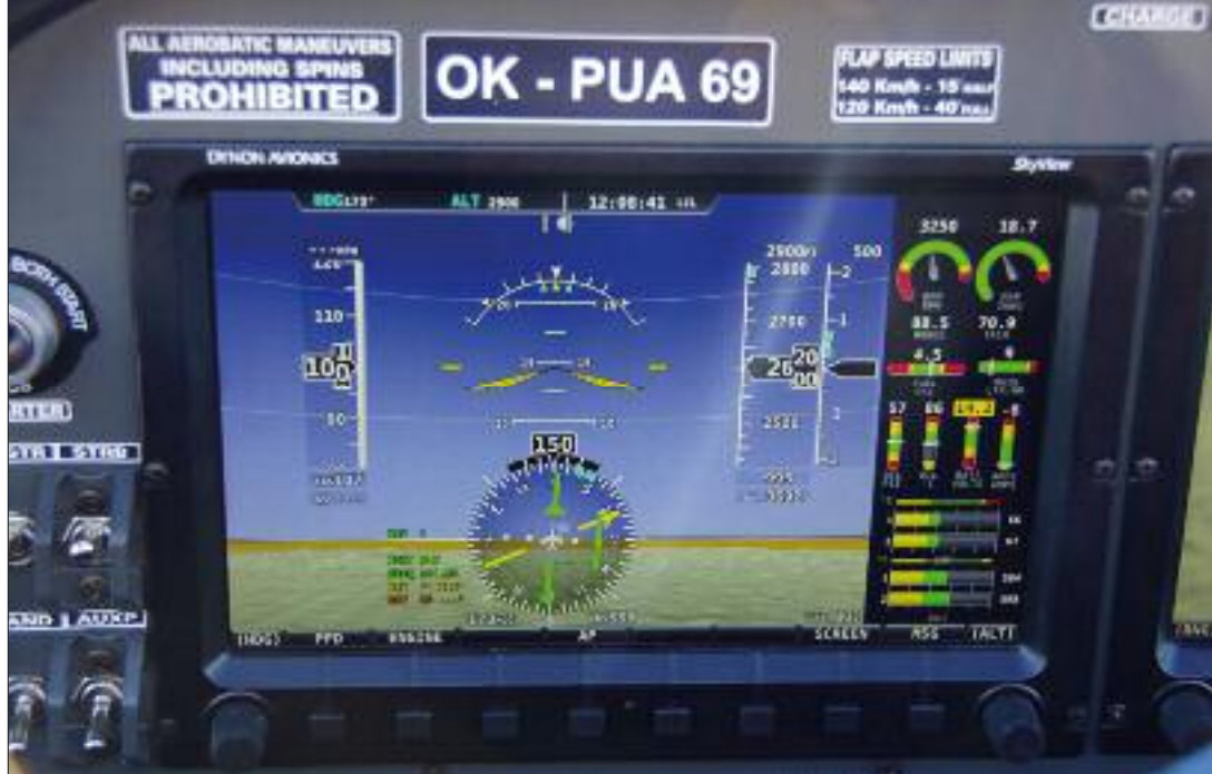
Zintegrowany z autopilotem EFIS Dynona
